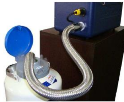
Injeção automática de N2L do botijão para a máquina
