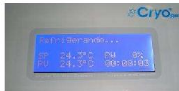
Controlador digital com indicação da temperatura desejada SP , temperatura real PV , potência do evaporador PW e tempo decorrido
