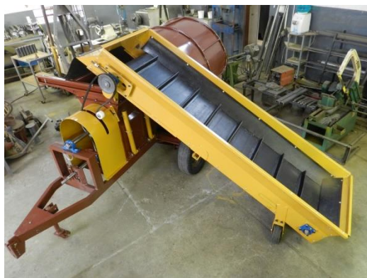
Esteira com grande inclinação e base ampliada garante alta produtividade
